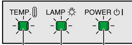
TEMP.-Anzeige (Temperatur-Warnung)    LAMP-Anzeige (Lampenaustausch)    POWER-Anzeige (Netz)
