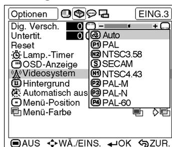
Die Videoeingangssystem-Betriebsart ist auf „Auto“ eingestellt und kann auf eine spezifische System-Betriebsart geändert werden, wenn die gewählte Betriebsart nicht mit dem angeschlossenen audiovisuellen Gerät kompatibel ist.
