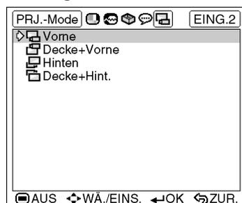
Dieser Projektor ist mit einer Kehrbild-/Umkehr-Funktion ausgestattet, mit der das Bild für unterschiedlichen Anwendungen als Kehrbild bzw. Umkehrbild projiziert werden kann.
