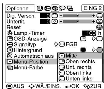
Diese Funktion ermöglicht die Einstellung der gewünschten Position des Menübildschirms.
