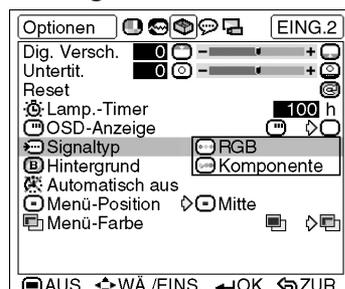
Diese Funktion ermöglicht den Eingangssignaltyp Komponente oder RGB für EING. 2 auszuwählen.
