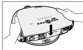
Drücken Sie den Projektor zum Anbauen an den Drehständer kräftig nach unten und vergewissern Sie sich, dass er sicher auf dem Drehständer angebracht ist.
