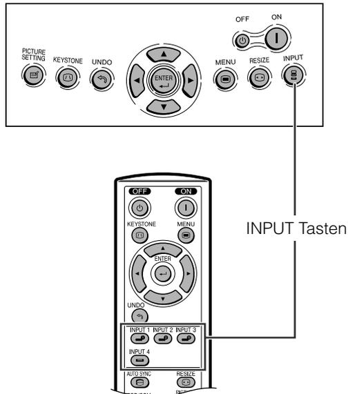
Drücken Sie **INPUT** am Projektor, **INPUT 1**, **INPUT 2**, **INPUT 3** oder **INPUT 4** auf der Fernbedienung, um den gewünschten Eingangsmodus auszuwählen.
