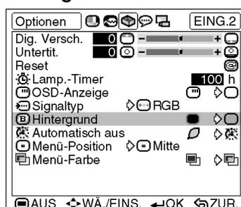
Mit dieser Funktion kann ein Bild gewählt werden, das angezeigt wird, wenn kein Signal an den Projektor gesendet wird.
