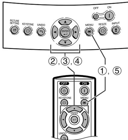
Bei der Anzeige von Computer-Mustern, die jeden Punkt wiederholen (Fliesenmuster, vertikale Streifen), können Interferenzen zwischen den DMD-Pixeln auftreten und ein Flimmern, vertikale Streifen oder Kontrastfehler in Bildteilen verursachen. In diesem Fall „Clock“, „Phase“, „H-Pos“ und „V-Pos“ für ein optimales Computer-Bild einstellen.
