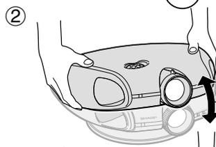
② Stellen Sie das projizierte Bild wie gewünscht ein, indem Sie den Projektor auf dem Drehstand anheben und drehen.
