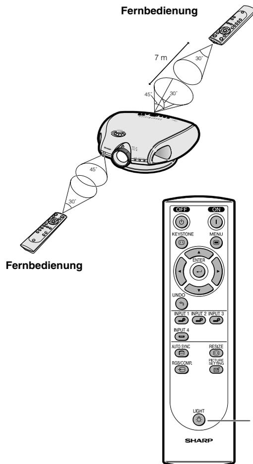
Mit der Fernbedienung kann der Projektor innerhalb des links aufgeführten Bereiches gesteuert werden.
