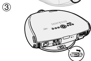
Bis zur  $\pm 3^\circ$  von der Standardposition einstellbar.
