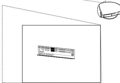
Platzieren Sie den Projektor in einem Abstand von der Bildwand, der die Projektion von Bildern auf die Bildwand ermöglicht und beachten Sie dabei den Abschnitt „Einstellung des Projektionsabstandes“ auf den Seiten 21 und 22.
