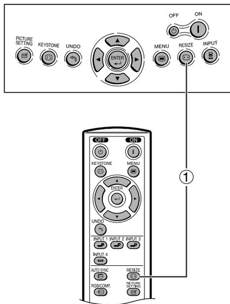
Mit dieser Funktion kann die Bildwiedergabe-Betriebsart zur Verbesserung des eingegebenen Bildes modifiziert und eingestellt werden. Abhängig vom Eingangssignal kann ein Bild im Format NORMAL, UMRANDUNG oder STRECKEN gewählt werden.
