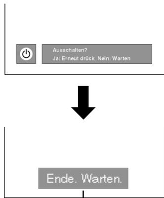
Um gegen Lampenschäden vorzubeugen, wird etwa 20 Sekunden lang ein schemenhaft beleuchtetes Bild angezeigt.
